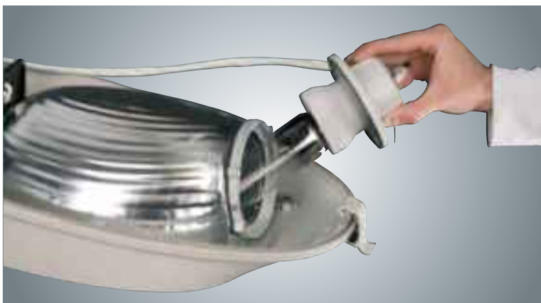
Accesso al vano ottico per la sostituzione lampada tramite tappo in alluminio apribile con 1/4 di giro senza l'ausilio di utensili
