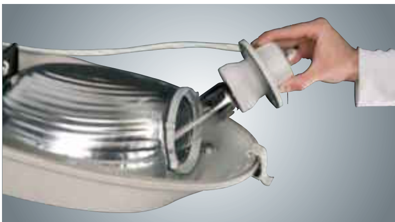
Accesso al vano ottico per la sostituzione lampada tramite tappo in alluminio apribile con 1/4 di giro senza l'ausilio di utensili
