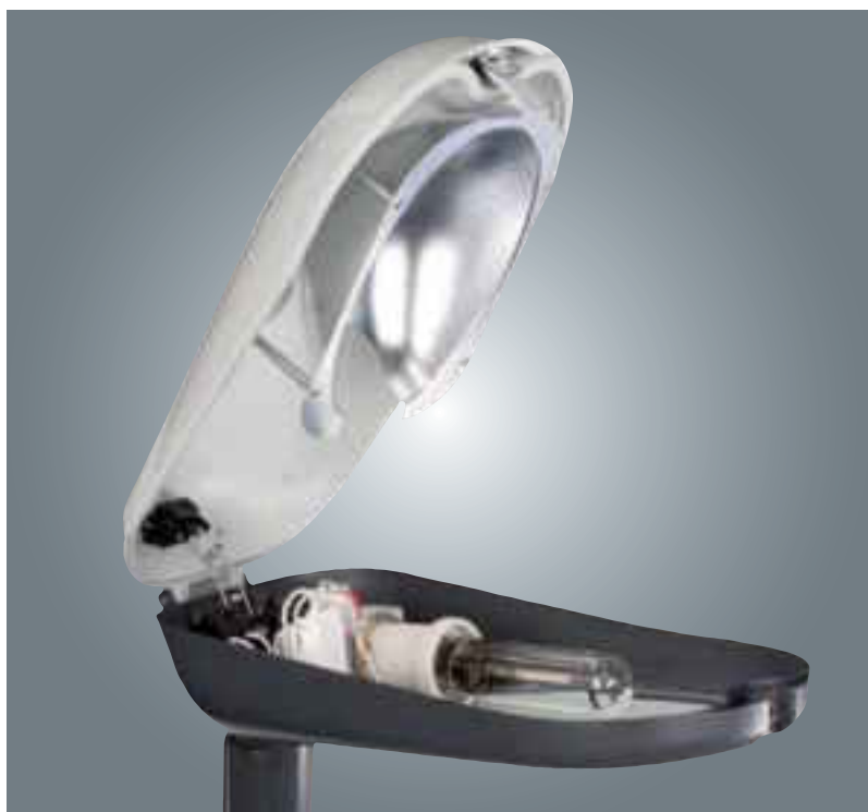
Piastra asportabile senza l'utilizzo di utensili, Cablaggio in Classe II con sezionatore automatico all'apertura della calotta.
