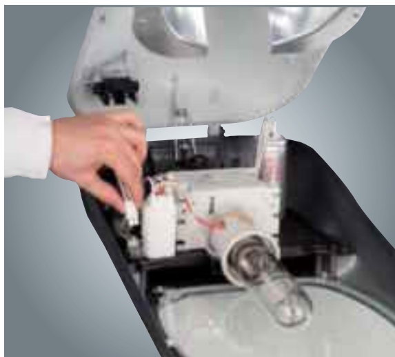
Piastra asportabile senza l'utilizzo di utensili, Cablaggio in Classe II con sezionatore automatico all'apertura della calotta.
