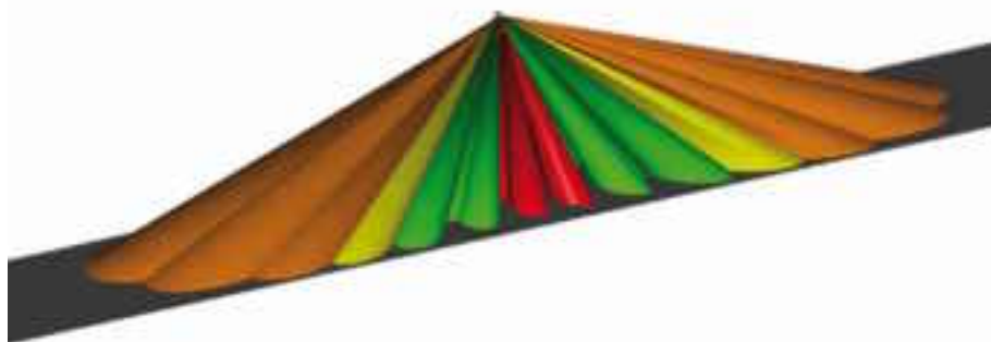
Esempio di studio 3D di distribuzione raggi luminosi di un apparecchio ST500 in codizioni standard.
